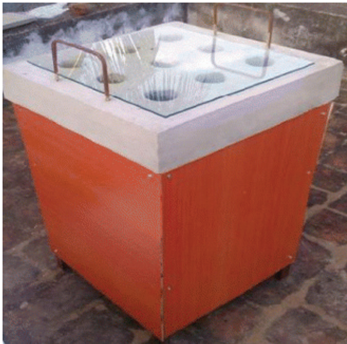
Slika 13 • Testni model s strešno betonsko ploščo z luknjami, v katerih je PCM (povzeto po (Mannivannan, 2015)).
